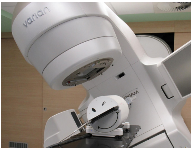
Abb. 3: Körperäquivalentes Mess-Phantom Octavius®
